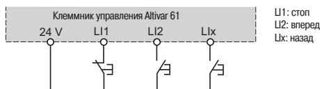
Схема соединений при трехпроводном управлении
